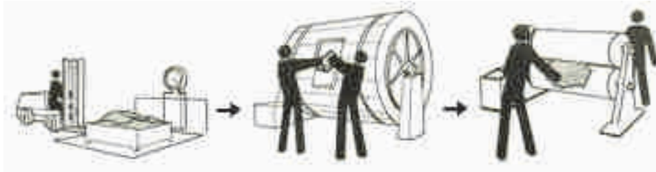
Слика бр. 24 – Мерење, штавење и цедење на кожи.
