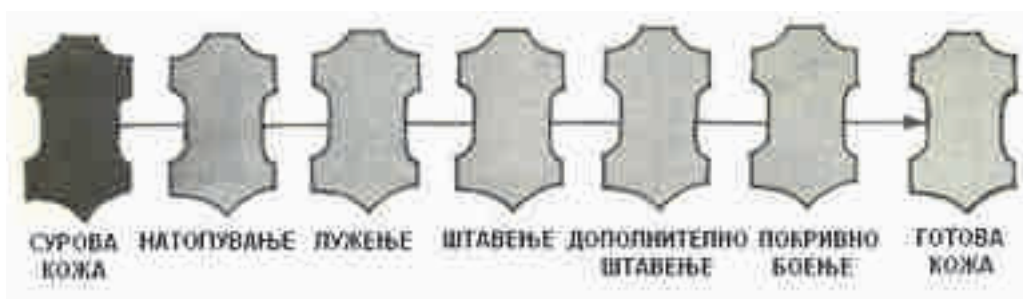
Слика бр. 1 – Основни операции на преработка на сурова кожа, до готова кожа
