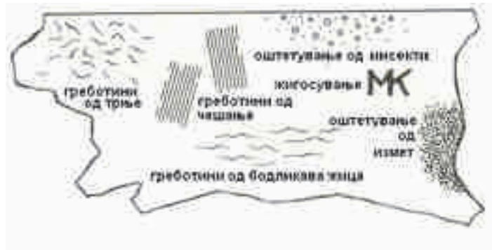
Слика бр. 15 – Оштетувања на суровата кожа.
