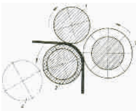
Слика бр. 18 – Шема на машина за симнување на покожинка и влакна: 1) горен транспортен валјак, 2) гумен валјак во положба кога машината работи, 3) валјак со ножеви, 4) гумен валјак во слободна положба.
